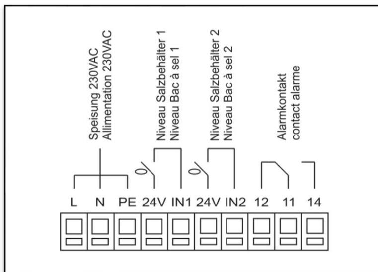
**Ausführung:** Kompakte Salzmangelanzeige zur vorzeitigen Anzeige bei geringem Salzniveau. Die Anzeige kann in der Nähe der Salzbehälter an die Wand montiert werden. Die Anzeige ist für ein oder zwei Salzbehälter erhältlich. Der Alarmkontakt wird ausgelöst sobald in einem der beiden Salzbehälter das voreingestellte Mindestniveau erreicht ist.
