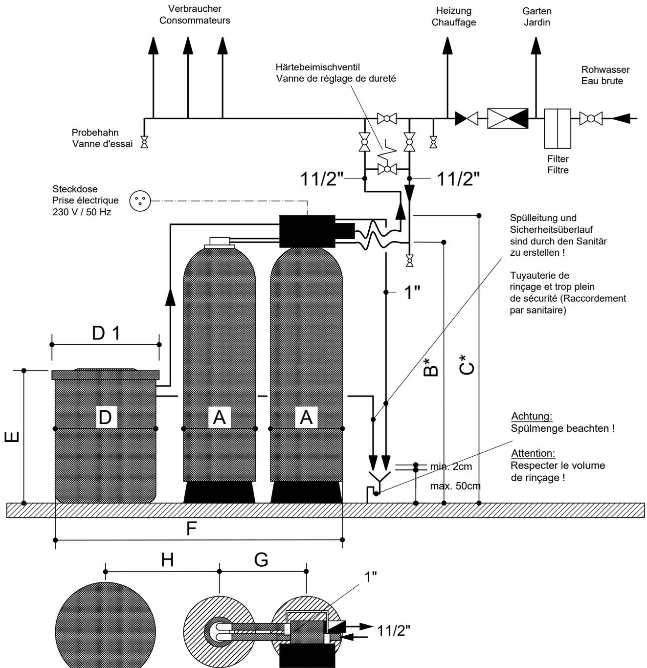
Spülleitung und Sicherheitsüberlauf sind durch den Sanitär zu erstellen !
